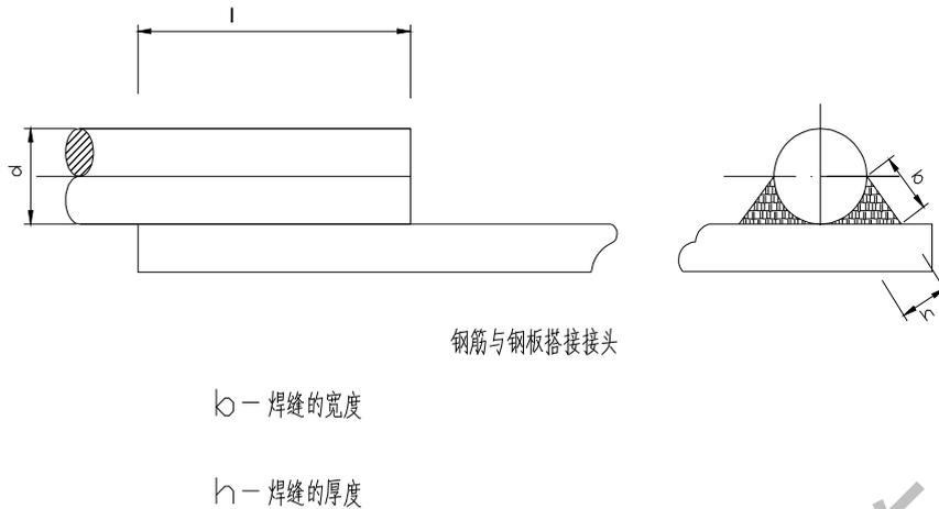
图 A. 3. 20 焊缝尺寸示意图
