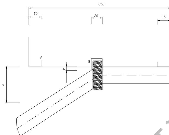
图 A. 3. 18 量测轴线折角示意图
