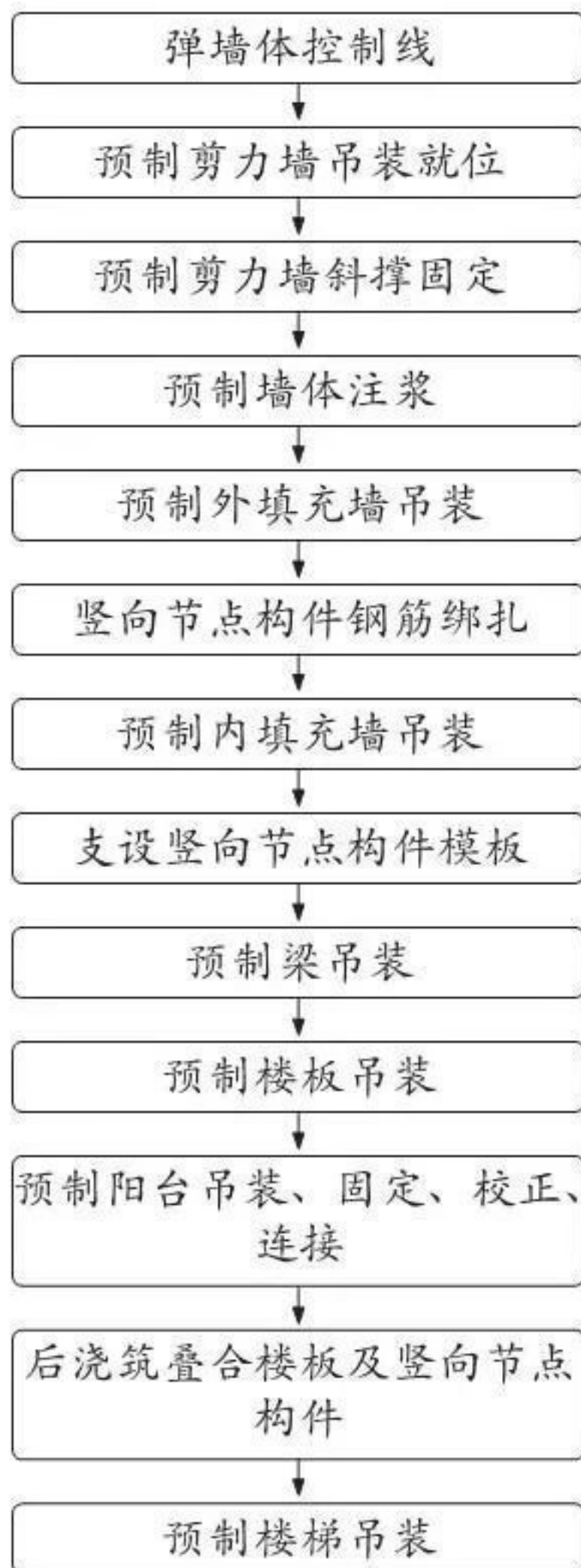
装配整体式剪力墙结构施工流程图
